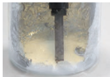
Zanieczyszczone elektrody srebrne mogą zostać oczyszczone za pomocą folii aluminiowej, soli (NaCl) i gorącej wody.
