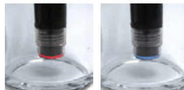
Migająca na czerwono i niebiesko sonda LDO w butli BZT podczas kalibracji.
