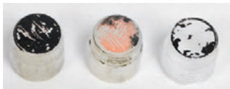
Zużyte/uszkodzone nasadki LDO
