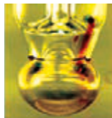
Poprawnie działająca membrana ceramiczna, wypływ elektrolitu (ciecz czerwona)
