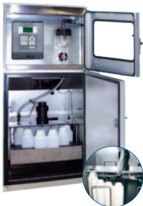
Bezpośrednie napełnianie 12 x 1-litrowych butelek z PE
