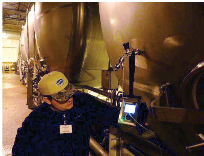
Rys. 4. Przenośny analizator tlenu Orbisphere 3100 wykorzystywany do weryfikacji online
