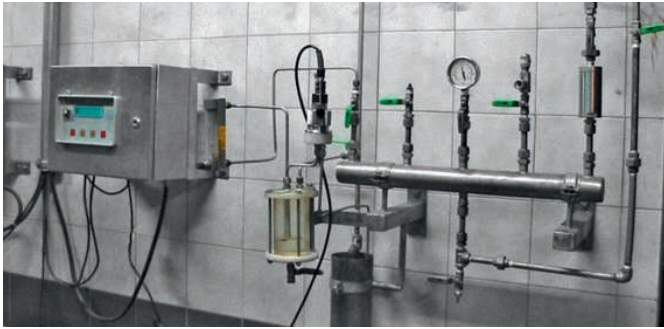
Rys. 3 – próbkowanie CO 2 za pomocą kuwety przepływowej 32001 i czujnika EC
