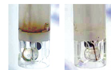
Skażony (strona lewa) i czysty (strona prawa) żel elektrolitowy
